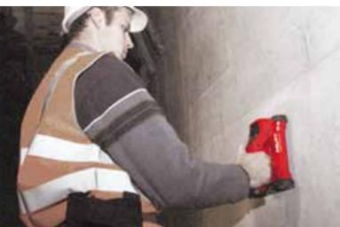
Revisión del recubrimiento de concreto: Comprobación del recubrimiento mínimo sobre amplias áreas de trabajo de reparaciones estructurales
